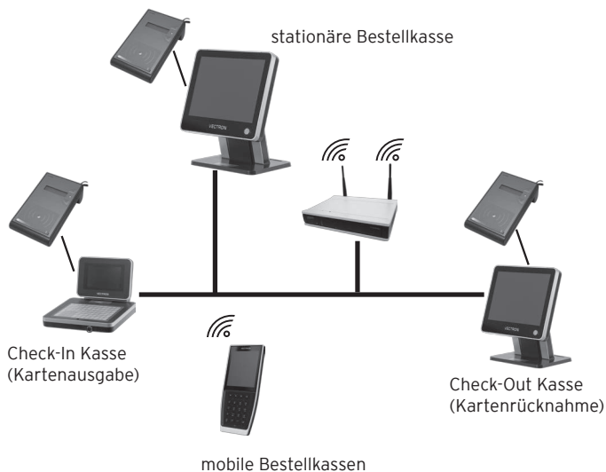
Abb. 4: Anwendungsbeispiel für ein serverbasiertes Inhouse-Zahlungssystem
