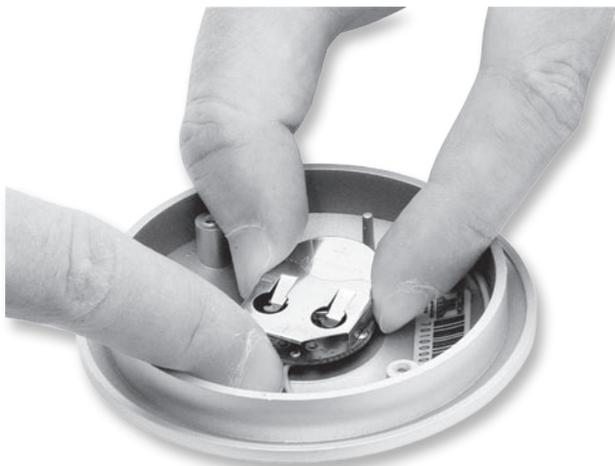
Fig. 10 : mise en place de la pile neuve
