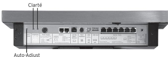
Fig. 9: Touches de réglage de la clarté de l'écran et Auto-Adjust
