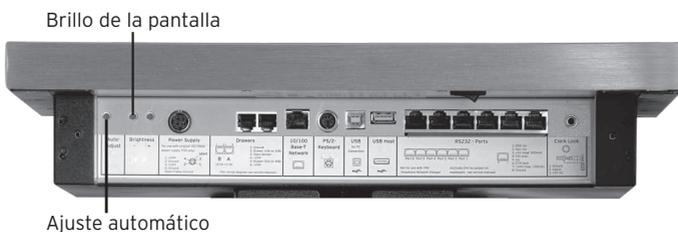
Fig. 9: Botones para el brillo de la pantalla y ajuste automático
