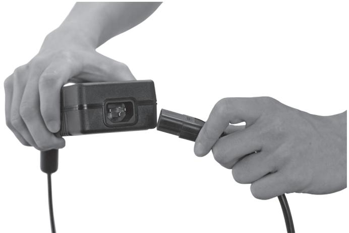
Abb. 39: Kaltgerätekupplung aus Kaltgeräteeinbaustecker ziehen
