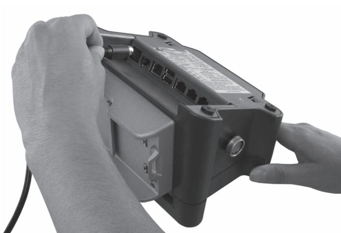
Abb. 38: Stromleitungsstecker aus Stromanschluss ziehen
