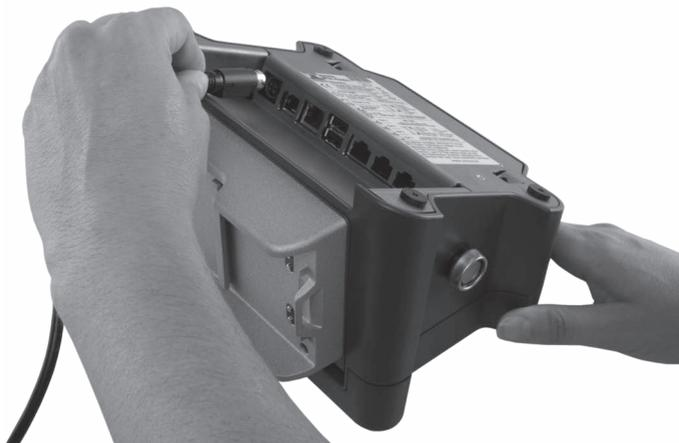
Abb. 14: Stromleitungsstecker in Stromanschluss stecken
