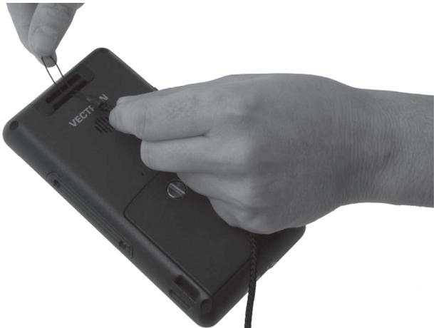
Fig. 27: Glisser la boucle à travers l'œillet
