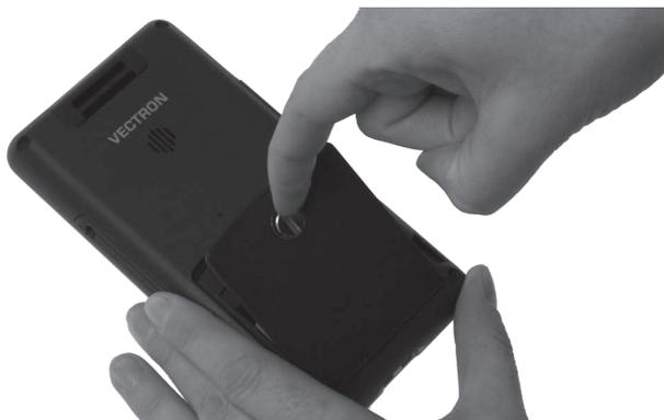
Fig. 18: Lever le couvercle du logement de batterie
