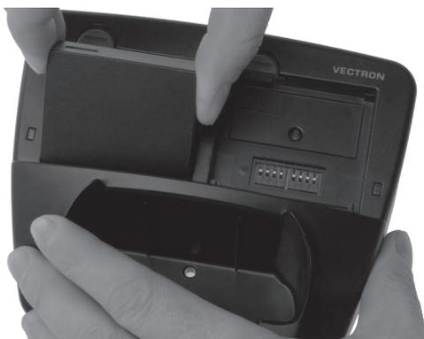
Fig. 15: Placez la batterie B50 dans le logement de batterie
