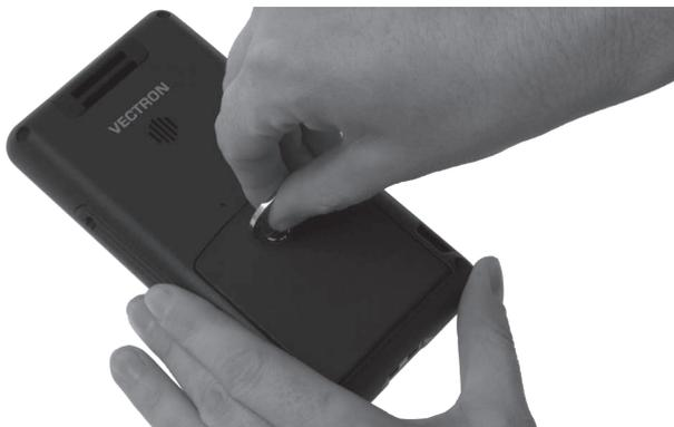
Fig. 41: Dévissage de la vis du logement de batterie
