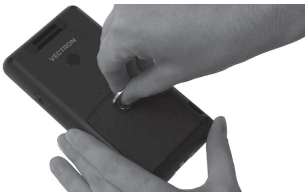
Fig. 53: Fixation de la vis du logement de batterie
