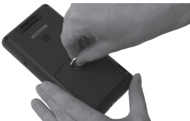
Fig. 21: Fixation de la vis du logement de batterie
