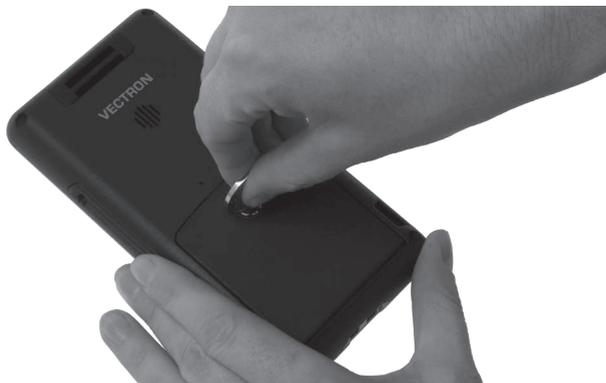
Fig. 50: Dévissage de la vis du logement de batterie
