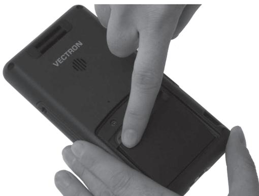
Fig. 45: Enclenchement de la batterie B50
