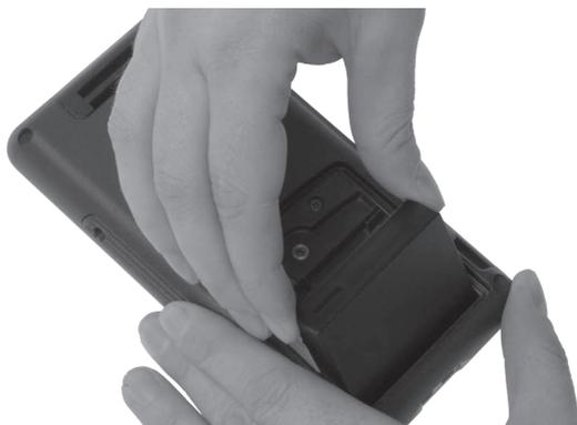
Fig. 19: Placez la batterie B50 dans le logement de batterie
