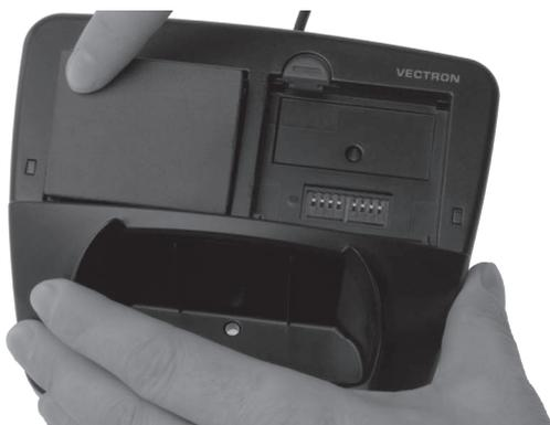
Fig. 16: Enclenchement de la batterie B50
