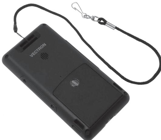
Fig. 29: Tirer la dragonne anti-chute à travers la boucle
