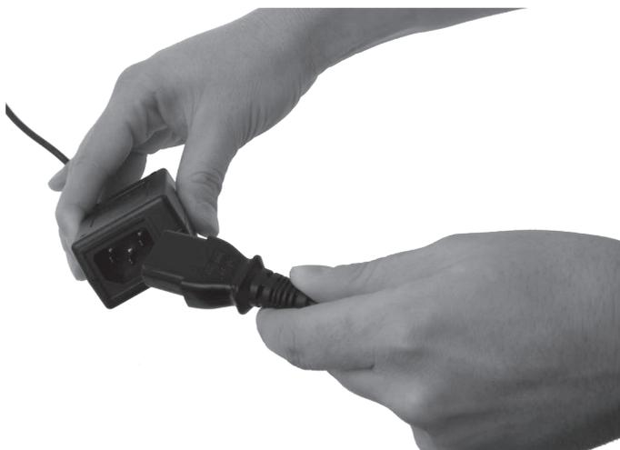
Fig. 14: Branchement du raccord d'alimentation dans la fiche d'alimentation
