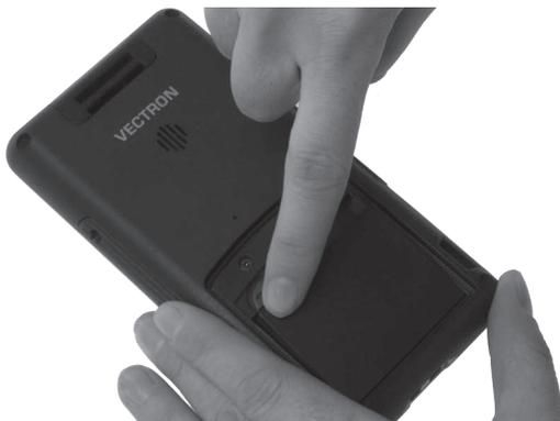
Fig. 20: Enclenchement de la batterie B50
