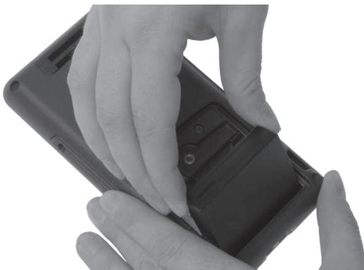
Fig. 44: Placez la batterie B50 dans le logement de batterie
