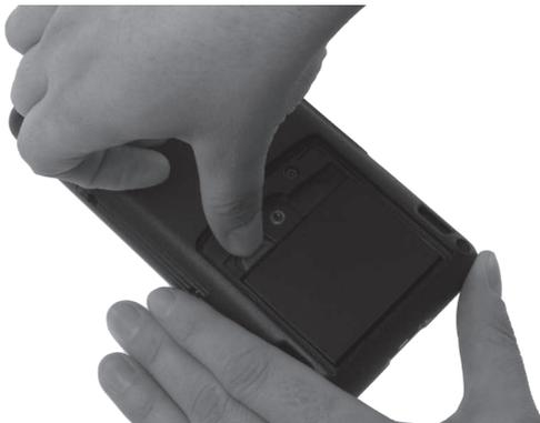
Fig. 43: Actionnement du déverrouillage de batterie
