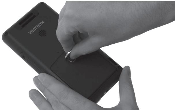
Fig. 46: Fixation de la vis du logement de batterie
