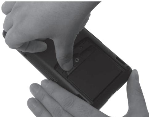
Fig. 52: Actionnement du déverrouillage de batterie
