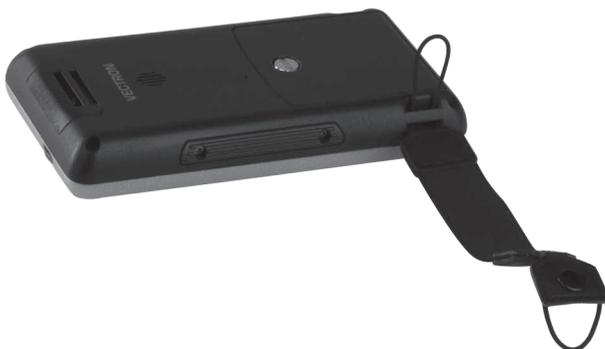
Fig. 23: Glisser la boucle à travers l'œillet
