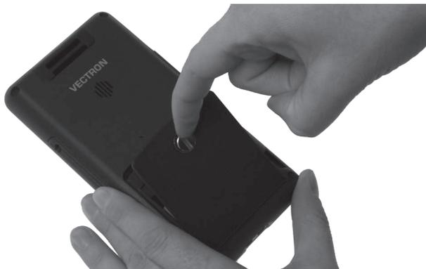
Fig. 51: Lever le couvercle du logement de batterie
