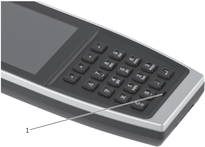
Abb. 30: Kerbe im Tastenführungsgitter
