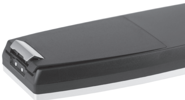
Abb. 26: Verriegelung des Akkufachdeckels öffnen
