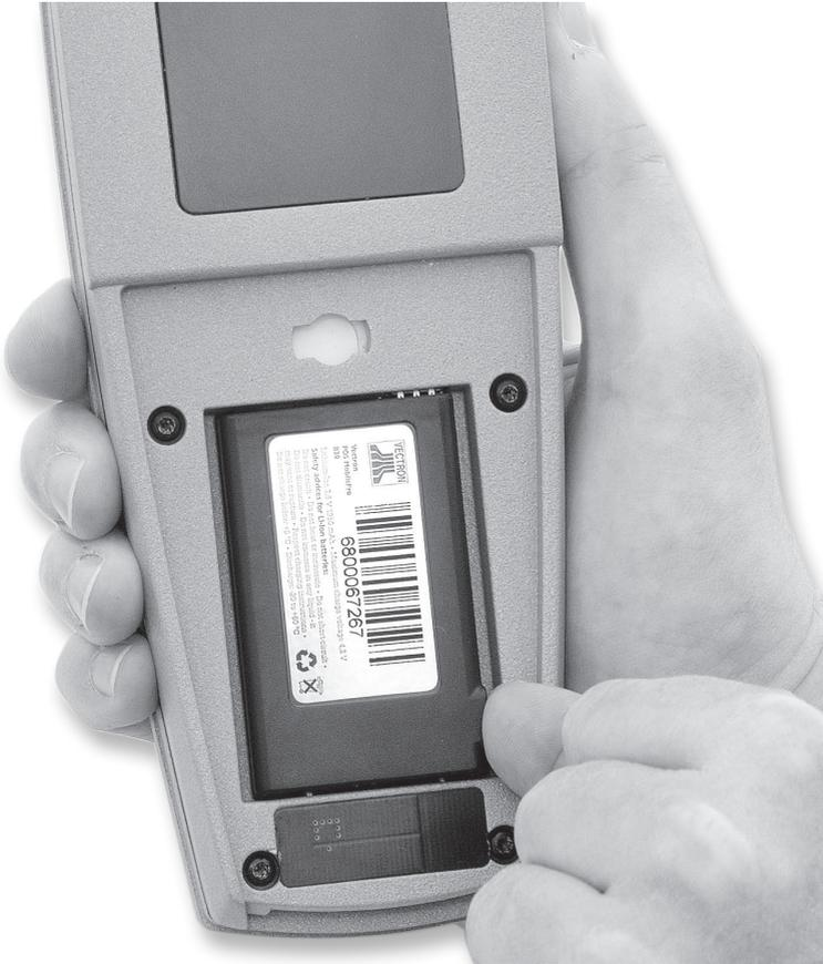
Fig. 7: soulèvement de la batterie
