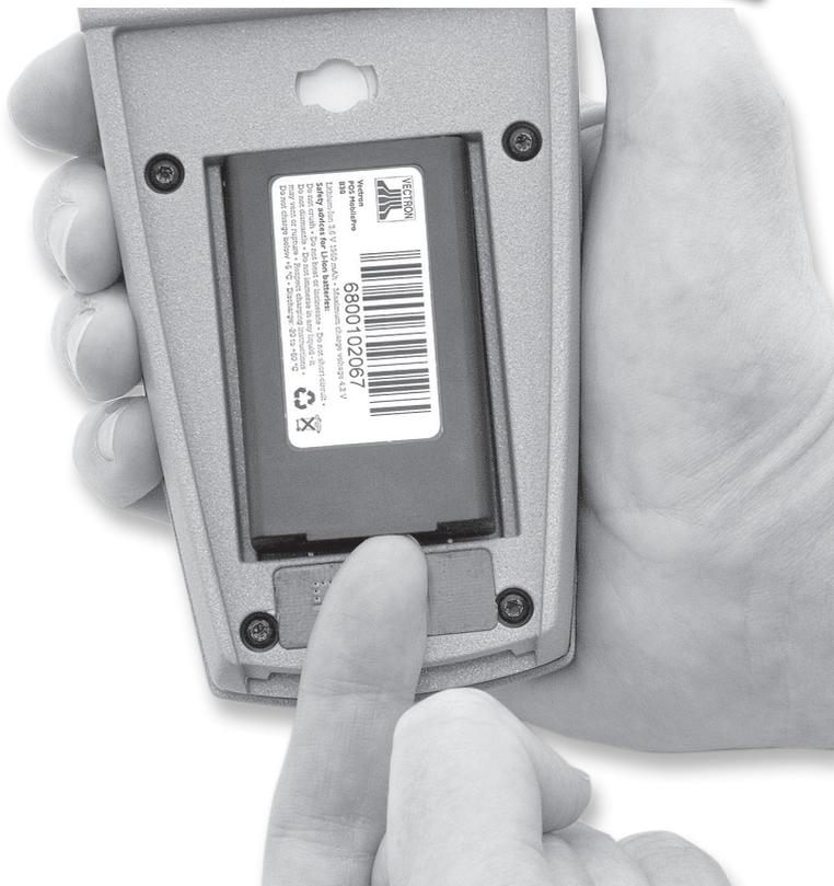
Abb. 8: soulèvement de la batterie
