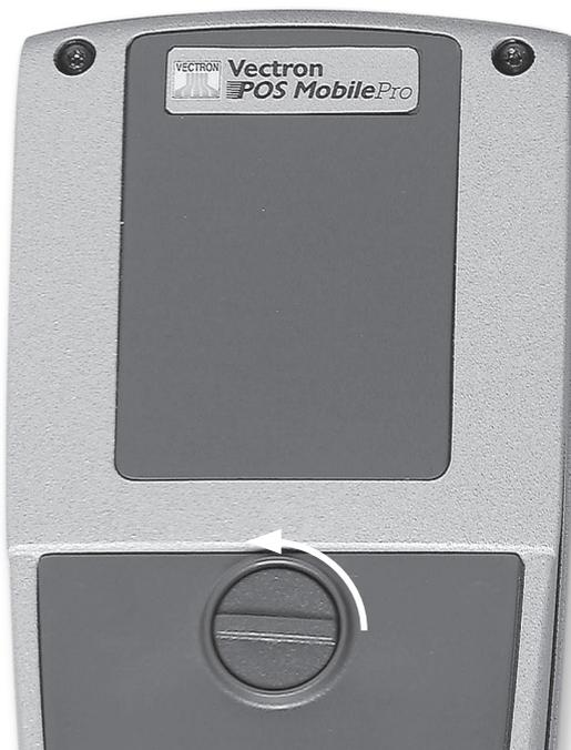
Fig. 4 : ouverture du couvercle du logement de la batterie
