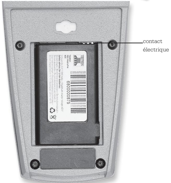
Fig. 10 : batterie en place
