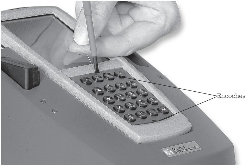
Fig. 23 : soulèvement de la grille du clavier
