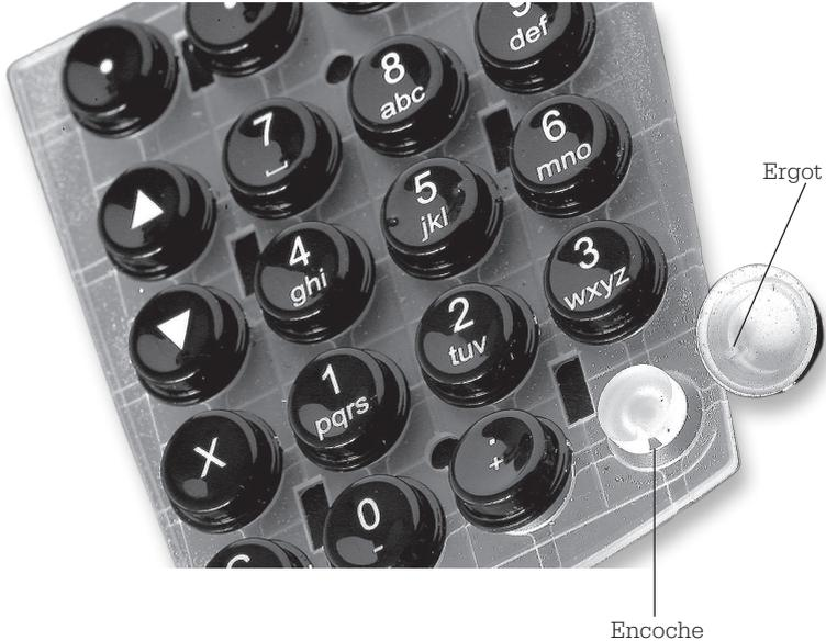
Fig. 28 : pose des touches du clavier
