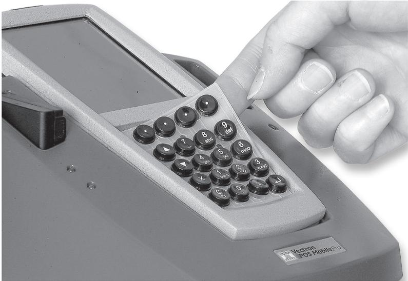
Fig. 26 : enlèvement du clavier souple
