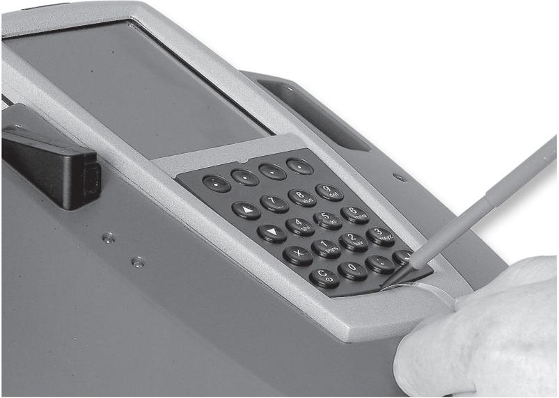
Fig. 24 : soulèvement de la grille du clavier
