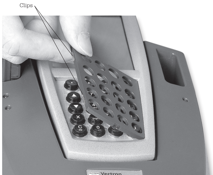
Fig. 29: Colocación por los lados de la parrilla del teclado
