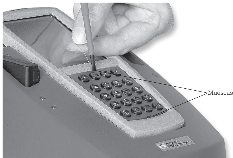
Fig. 23: Extracción de la parrilla del teclado
