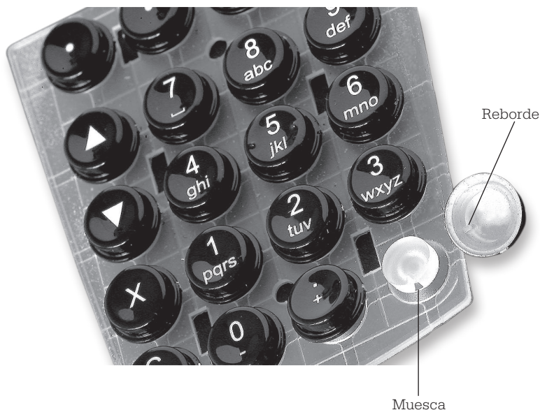
Fig. 28: Colocación de las capuchas de tecla
