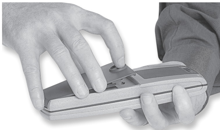
Fig. 12: Cierre del compartimento de la batería
