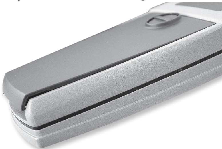
Fig. 13: Tapa del compartimento de la batería incorrectamente cerrada
