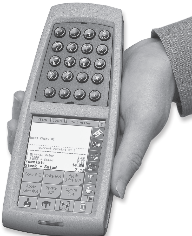
Fig. 18: Vectron POS MobilePro con sensor de inclinación activado
