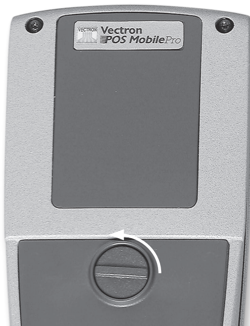
Fig. 4: Apertura del cierre del compartimento de la batería
