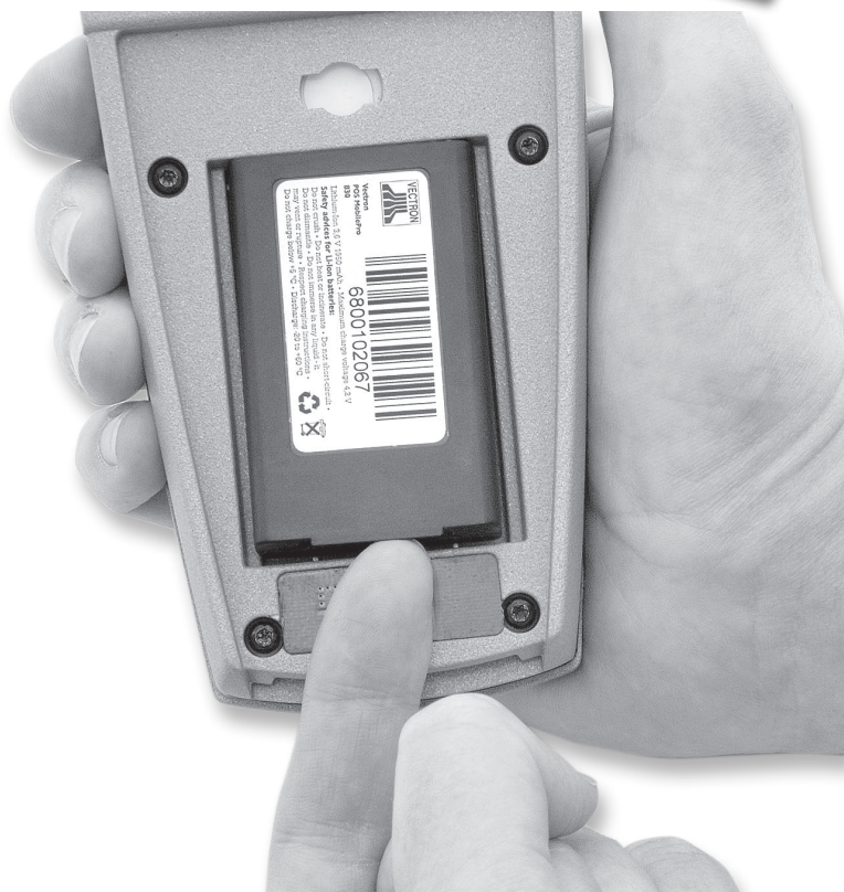
Fig. 8: Alzado de la batería
