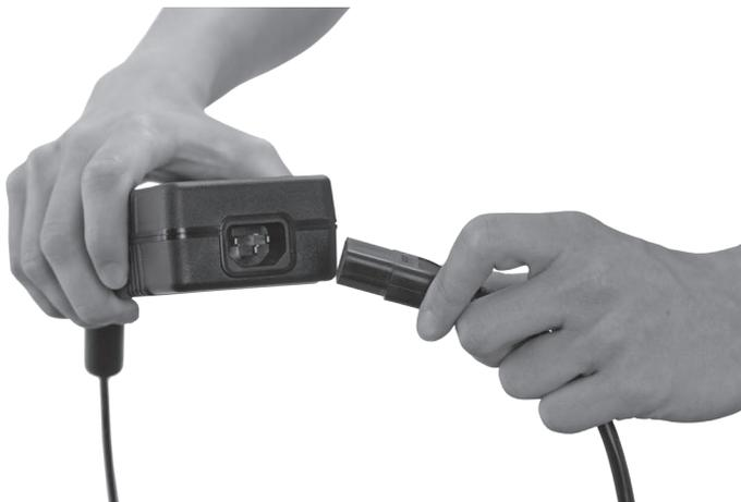
Fig. 42: Desconectar la conexión IEC del enchufe IEC incorporado
