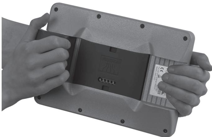
Fig. 31: Colocar la batería B40 en el sistema de terminal MobilePad
