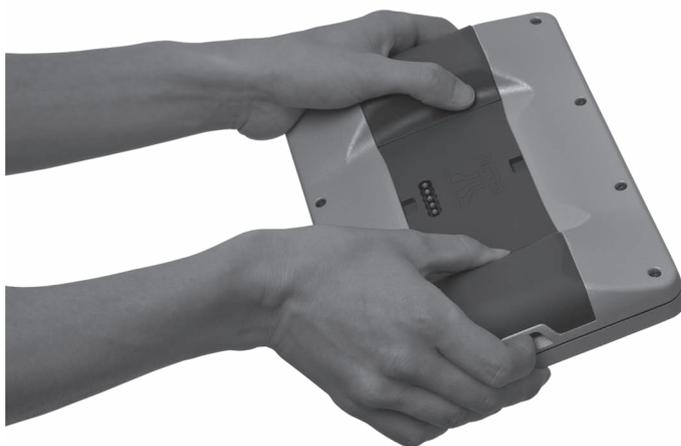
Fig. 33: Desenganchar la batería B40
