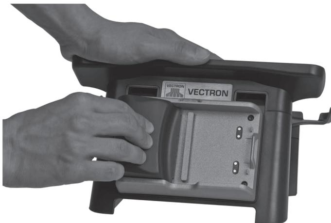
Fig. 16: Colocar la batería B40 en el compartimento de la batería
