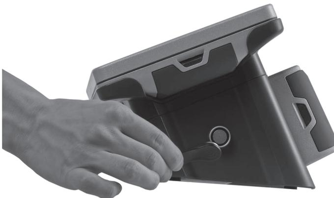
Fig. 36: Mantener la llave en la cerradura de empleado
