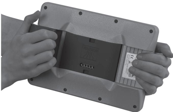
Fig. 18: Colocar la batería B40 en el sistema de terminal MobilePad
