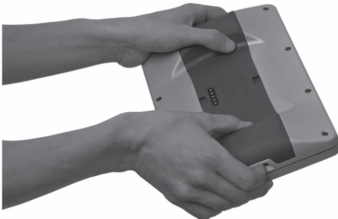
Fig. 30: Desenganchar la batería B40
