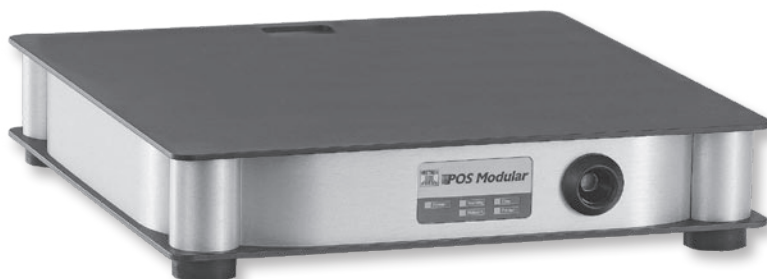
Fig. 1 : Vectron POS Modular avec serrure d'identification « Addimat »
