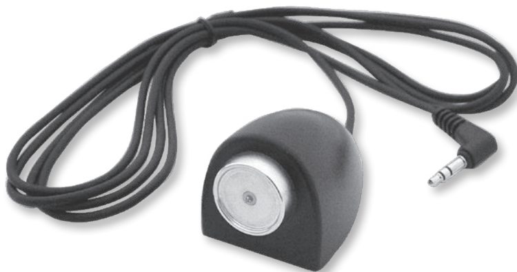
Fig. 3 : serrure d'identification externe Dallas iButton Magnet
