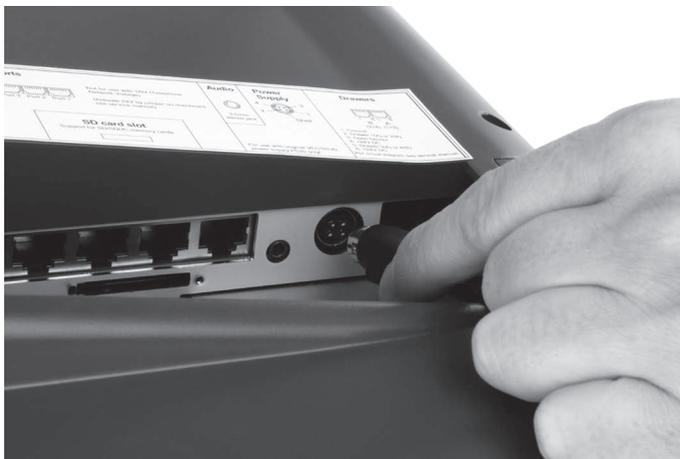
Fig. 24: Retirar el conector de la línea de corriente de la conexión eléctrica
