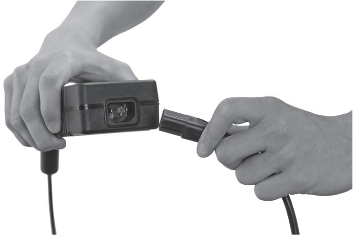
Fig. 13: Enchufar el conector IEC en el enchufe IEC
