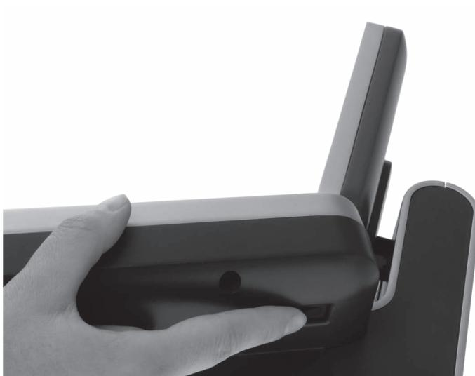
Fig. 22: Apagar y encender el Mini II
