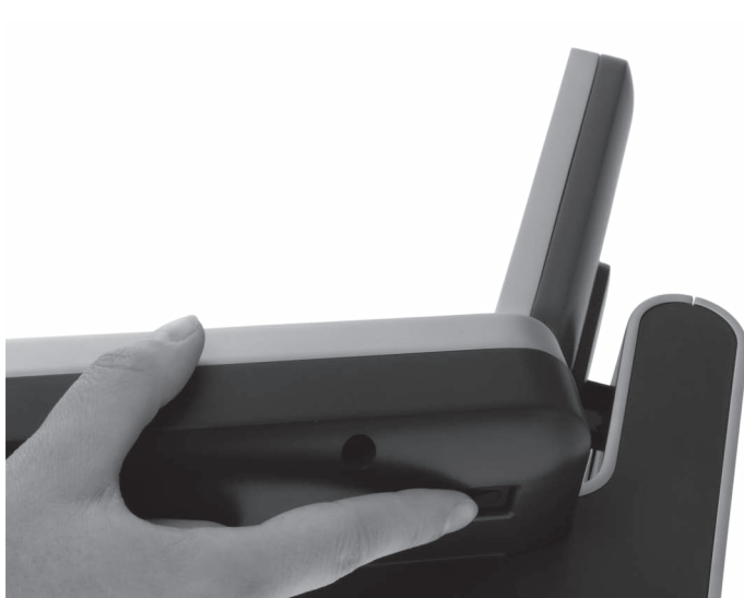
Fig. 22: Switching on and off Mini II
