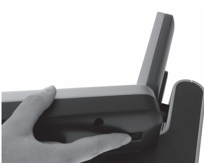
Fig. 16: Switching on the Mini II
