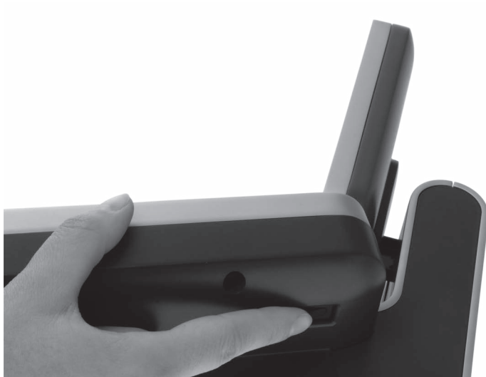
Fig. 23: Switching off the Mini II
