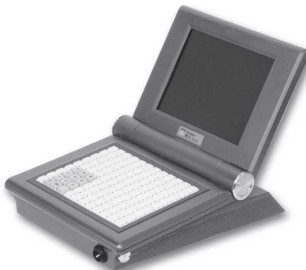
Fig. 1: Vectron POS Vario con teclado de chiclet
