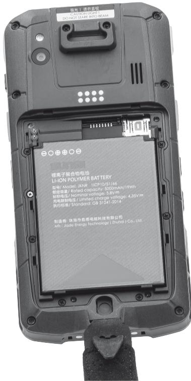
Fig. 18 : Couverture du logement de la batterie retiré
