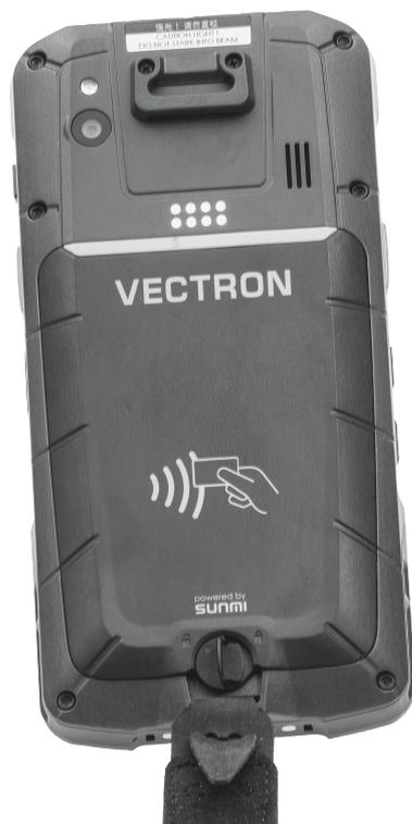
Fig. 13 : Ouvrir le verrou du couvercle du logement de la batterie
