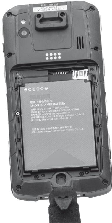
Fig. 17 : Batterie insérée
