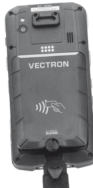
Fig. 14 : Ouvrir le couvercle du logement de la batterie
