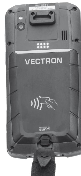
Fig. 12 : Ouvrir le verrou du couvercle du logement de la batterie
