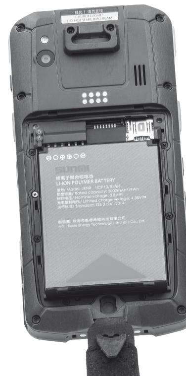
Fig. 16 : Insérer la batterie
