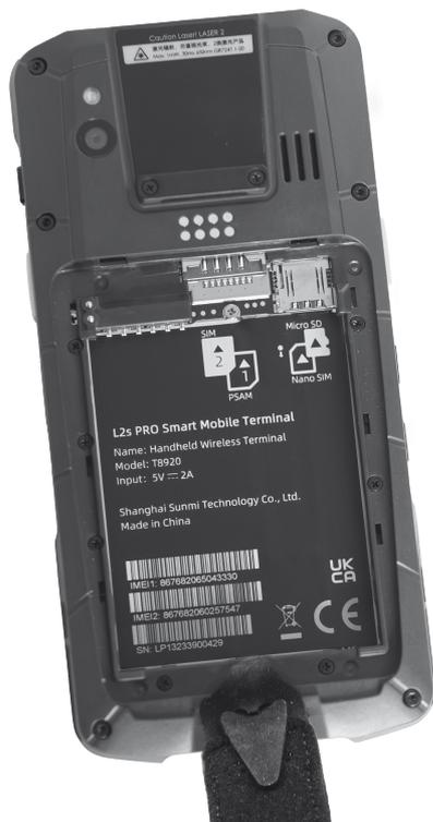
Fig. 15 : Couvercle du logement de la batterie retiré
