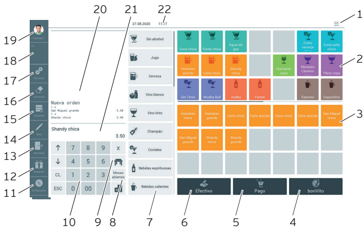
Fig. 19: Panel de registro
